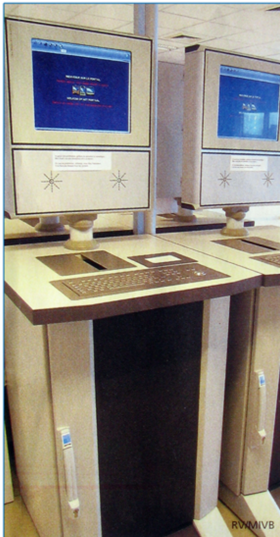
Un terminal de la STIB: il s'agit d'une Industrial Workstation de Rittal, également utilisée par les constructeurs de machines et les intégrateurs de système.
